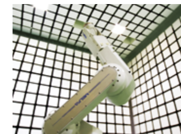
EMC中心（大型电波暗室）
