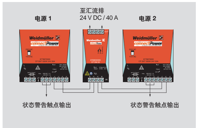
图(4)两台 40 A 电源并联
