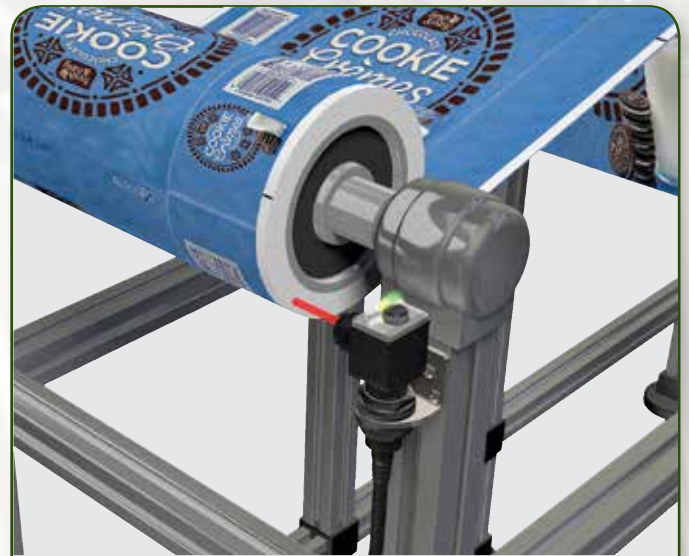
卷材检测 - 42EF RightSight LaserSight 可监视薄膜卷, 指示薄膜不足的情况。
