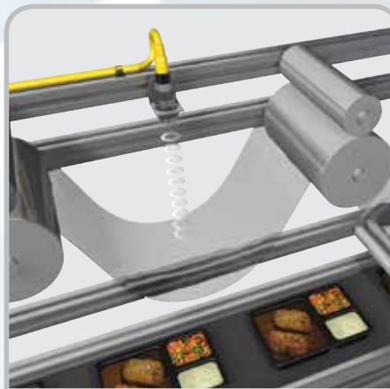
薄膜位置检测 - 873M 超声传感器能够对连续输送的透明卷料进行检测，同时监测张力。
