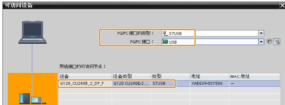
图 5-14 在 Startdrive 中找到的变频器
