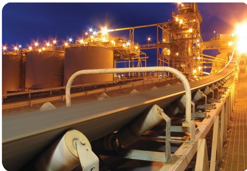
Gold Fields St Ives 的半自磨机主给料传送带以及上方的分级塔和湿式旋涡分级机是粉碎回路中的关键要素。
