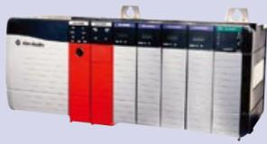
在开发过程中，安全与标准控制具有相同的规则，允许使用多个控制器、在线编辑和强制输入。一旦该项目经过测试并准备进行验证时，您需要将安全任务设置为 SIL 3 安全度等级，通过 GuardLogix 控制器将其强制实行。当安全内存锁定并保护起来时，不可修改安全逻辑，并且所有安全功能以 SIL 3 等级运行。在 GuardLogix 控制器的标准方面，所有功能都与普通 Logix 控制器的运行相同。因此在线编辑、强制以及其他功能都可使用。
