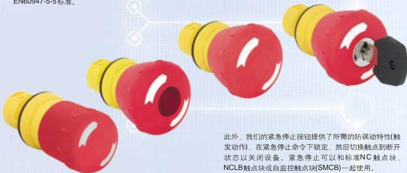
此外，我们的紧急停止按钮提供了所需的防误动特性(触发动作)，在紧急停止命令下锁定，然后切换触点到断开状态以关闭设备。紧急停止可以和标准NC触点块、NCLB触点块或自监控触点块(SMCB)一起使用。
