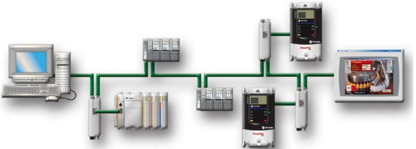
图 2 - 设备级环型拓扑使得 EtherNet/IP 设备(配有两个网络端口)可以直接连接到邻近的节点以构成环型拓扑。
