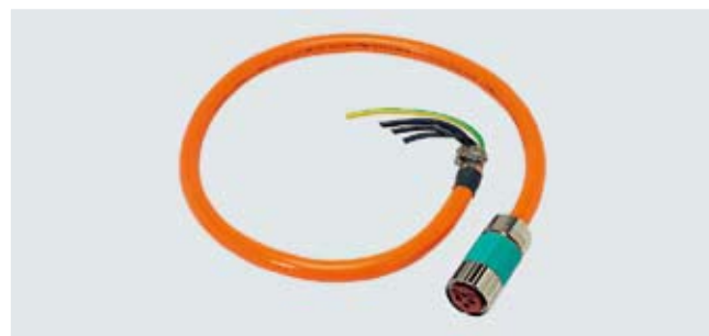
电机侧圆形端子头，用于PM340模块和带插头的1FK/1FT电机
