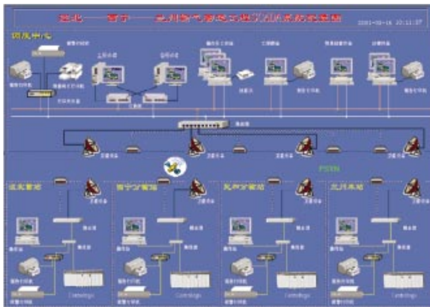
SCADA系统配置图
