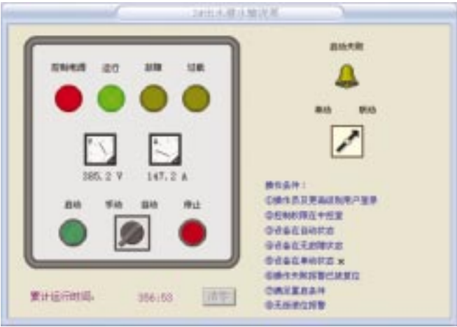
图10 现场操作柜人机界面画面
