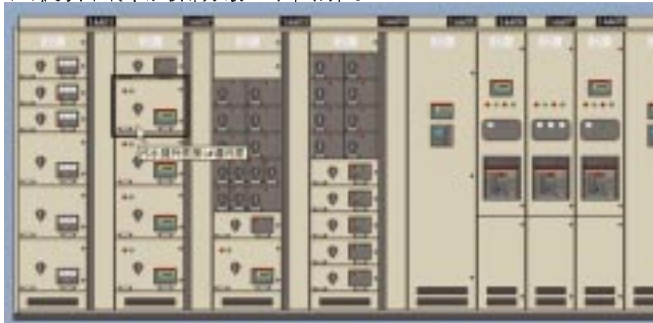
图8 380伏配电柜人机界面画面
