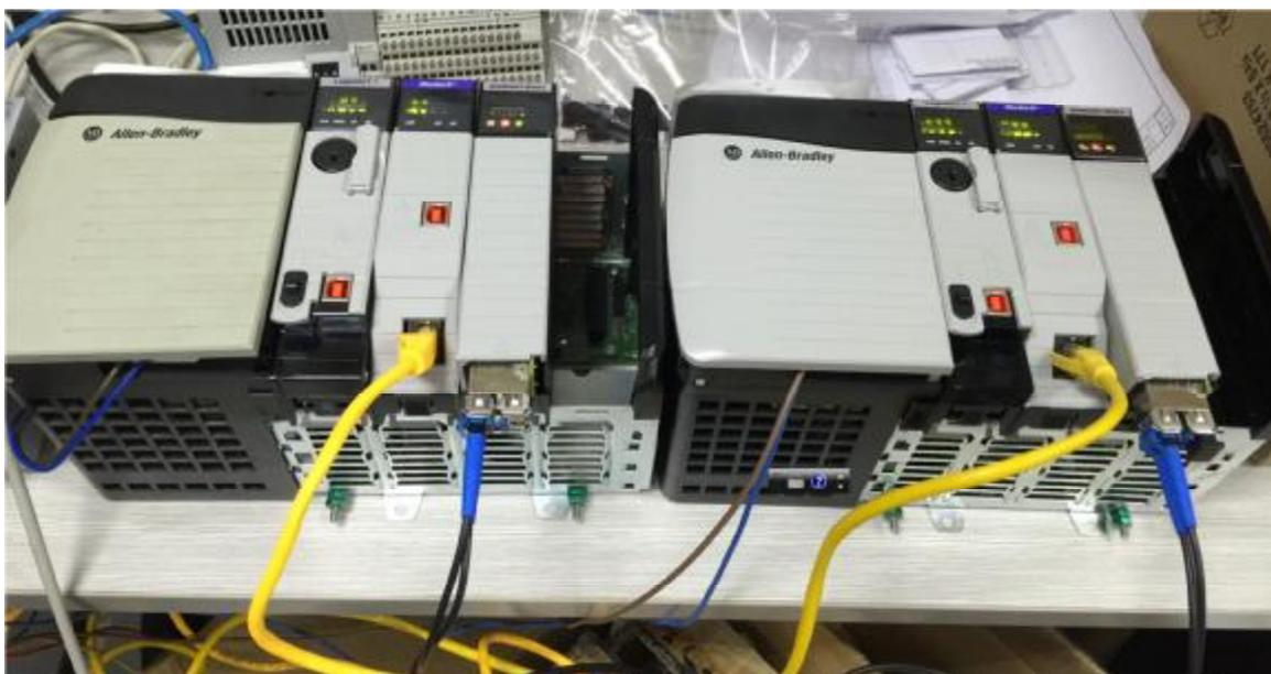
第一步保证 1756-EN2T 都连接在交换机上。1756-RMC1 光纤跳线连接在两块 1756-RM2 CH1 或 CH2 上。
